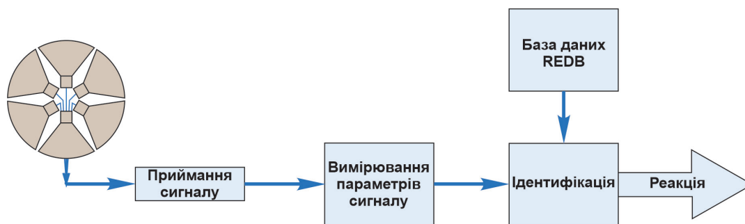
Рис. 3. Спрощена функціональна схема обладнання РТР
